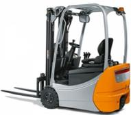
Destaques Motor trifásico de 24 volts com tração na roda traseira Programa de economia de energia Blue-Q Cinco programas selecionáveis de direção Excelente estabilidade na direção com o Controle otimizado de Velocidade em Curvas
